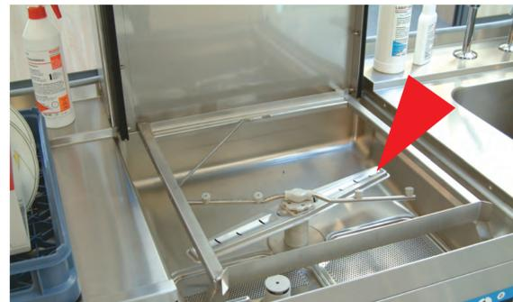
Regelmäßige Prüfung, bzw. Reinigung der Spülarms und Düsen.
