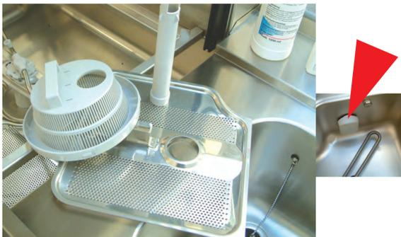
Nach jedem Wasserwechsel Siebe/Filter/Elektrode reinigen.
